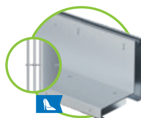
5 Système à fente à fente 2S, anti-talon, classe C, LF 2x6 mm, acier galvanisé ou inoxydable
