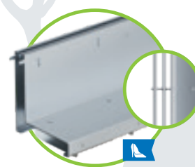
5 Système à fente 2S, anti-talon Classe C, LF 2x6 mm, acier galvanisé et inoxydable
