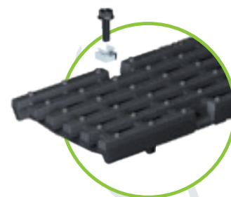
9 Grille à barres longitudinales en fonte ductile, Classe E, LM 22/13, boulonnée en 4 points, uniquement pour les cornières en fonte 2)
