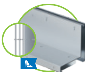
5 Système à fente à fente 2S, anti-talon, classe C, LF 2x6 mm, acier galvanisé ou inoxydable
