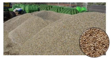
Figure 6 : Matériau de gravier de 4 à 8 mm recommandé pour le remblai
