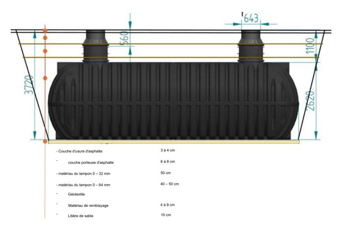
Slika 14 : Vue en coupe d'une installation correcte
