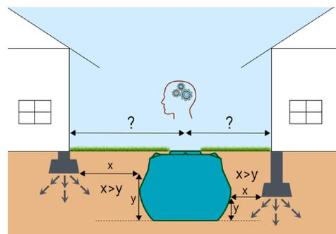
↓ **Près d'une construction**, ne pas poser la cuve dans une zone sollicitée mécaniquement par une fondation (cf. DTU 13.11 & 13.12).
