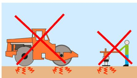
↓ **Ne pas utiliser d'engin de compactage** pour stabiliser le remblai de l'appareil. Utiliser du gravier auto compactant  $\varnothing < 15$  mm.
