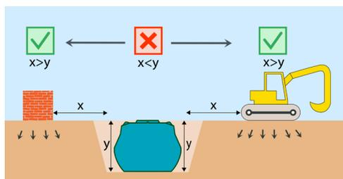
↓ En phase chantier, **baliser la zone d'implantation de la cuve** afin d'y interdire la circulation d'engin et le stockage de matériaux.
