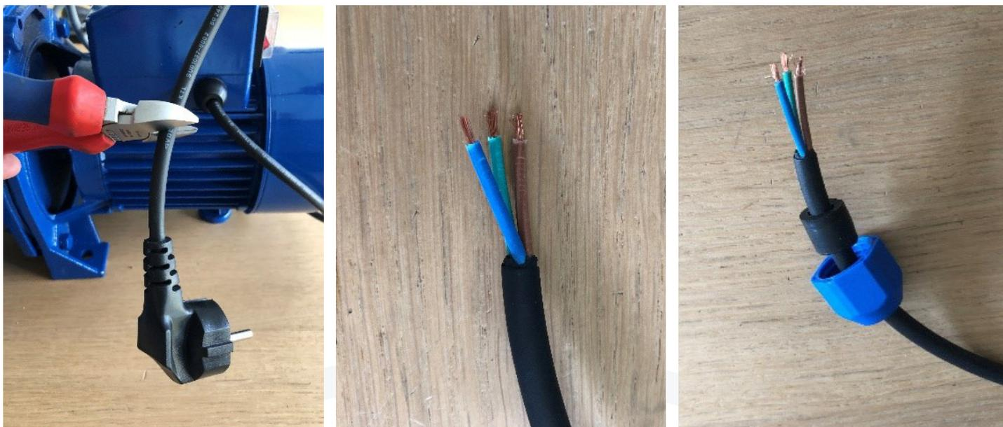
**Etape 6 :** Insérer le fil dans le boîtier du presscontrol. Brancher les fils dans le bornier vert. Visser le serre câble. Visser le press-étoupe.
