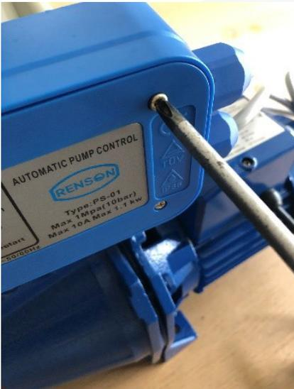
**Etape 4 :** Décabler le câble de sortie du presscontrol (câble n'ayant pas la prise de courant). Dévisser le press-étoupe puis le serre câble. Enlever le câble.
