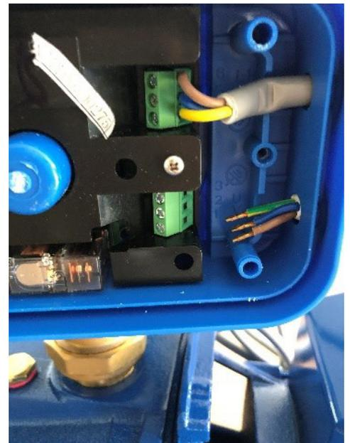
**Etape 5 :** Couper le câble afin d'enlever la prise. Dénuder les fils. Mettre le press-étoupe et le joint sur le fil.
