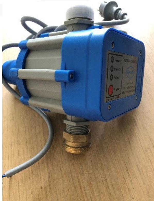
**Etape 2 :** Monter le presscontrol sur la pompe, en raccordant les deux parties de l'union.
