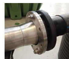
Vissage d'un connecteur à bride
