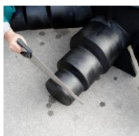
Coupe de l'embout étagé sur le tuyau souhaité
