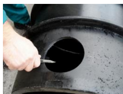
Nettoyage des bords de l'alésage
