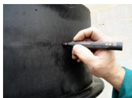
Marquage des trous de perçage
