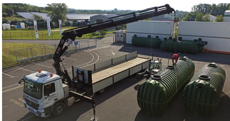
Exemple de chargement d'une cuve à l'aide d'une grue
