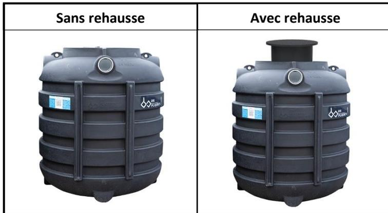
La rehausse permet d'enfuir plus profondément la cuve. Une profondeur supérieure permet de mieux la protéger des **changements de température** et des **perturbations extérieures**. Cela permet aussi de ne pas avoir les tubes d'entrée et de sortie ainsi que les canalisations trop proches de la surface.
