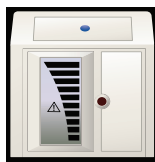
NIVEL DE LA PILA BAJO 16
