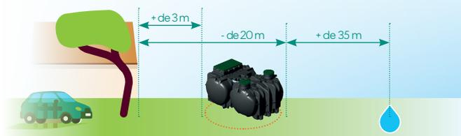
\* L'installation d'un bac à graisses est obligatoire si la distance est supérieure à 10 mètres.
