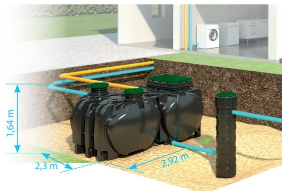
⚠ Attention : bien penser à introduire le remblai entre les deux cuves, dans l'espace prévu à cet usage. Si l'effluent doit subir une déviation angulaire en entrée ou sortie, utiliser des coudes à 45°.
