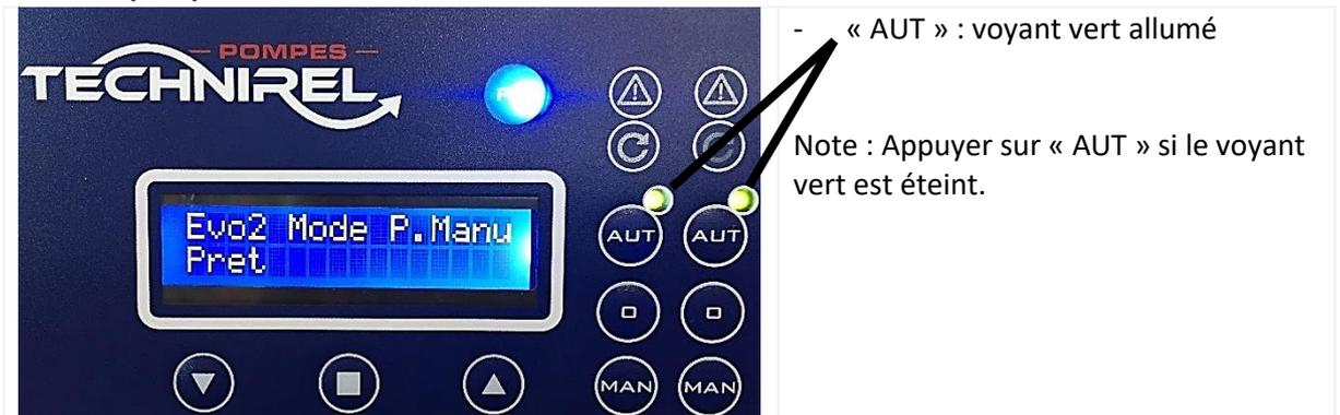
3. Vérifications : mettre en charge la station et vérifier le fonctionnement de la/des pompe(s)
