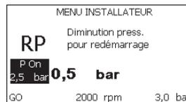
Figure 17 : Réglage de la pression de redémarrage
