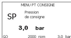
Figure 15 : Affichage d'un paramètre de menu
